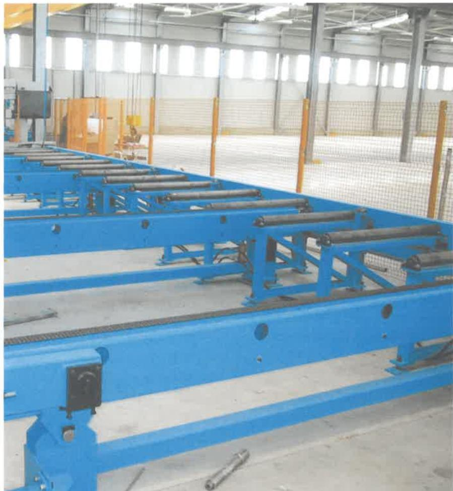
Sui telai sono posizionati una serie di rulli motorizzati e frizioni in modo da permettere l'avanzamento della trave spinta dal braccio posizionatore e successivamente l'estrazione delle travi tagliate.
